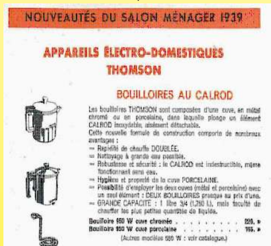
1939 Elementos calefactores Calrod fabricados en acero inoxidable (Documento del Museo Ultimheat)
